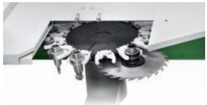
Инструментальный магазин револьверного типа на 13 или 16 мест.
